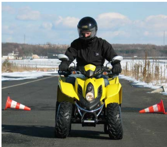
Abb.1 Versuchsfahrzeug Nr. 1, Hersteller: Sachs Quads, Typ T-Rex 50, Einzylinder-2-Taktmotor, 49 cm 3 , 2,6 kW, Leermasse 97 kg, (FE-Kl. S)
