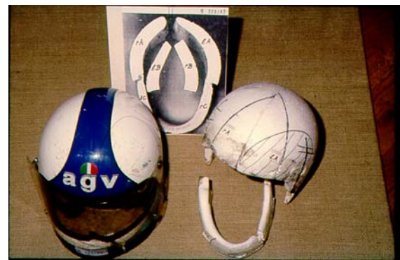
Abb.2 Laboruntersuchung eines unfallbeanspruchten Schutzhelmes mit entnommener und vermessener Schutzpolsterung
