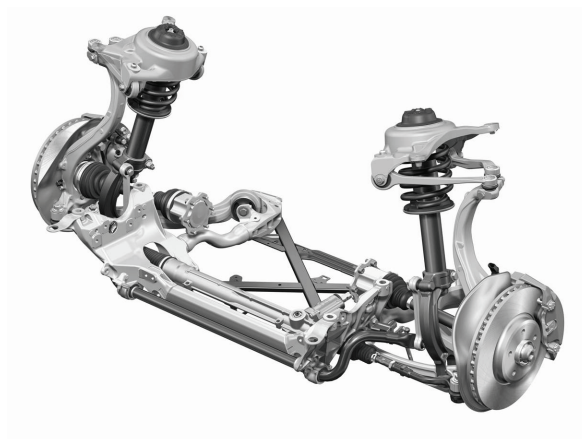
Abbildung 8.2: Fünflenker-Vorderachse des Versuchsfahrzeugs 264
