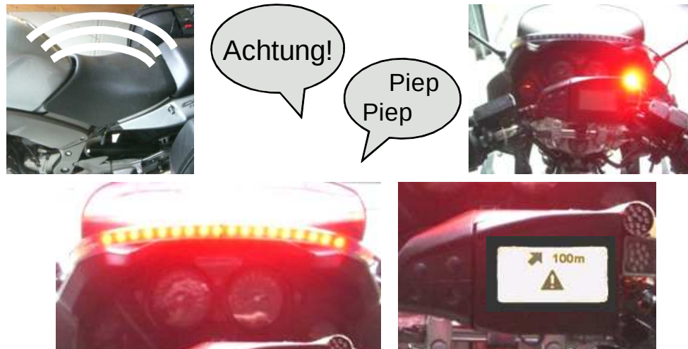
Abbildung 7.3: Übersicht der Warnelemente: Haptischer Sitz, Sprachwarnung/Warntöne, Warnblitzer, LED-Leiste, Display
