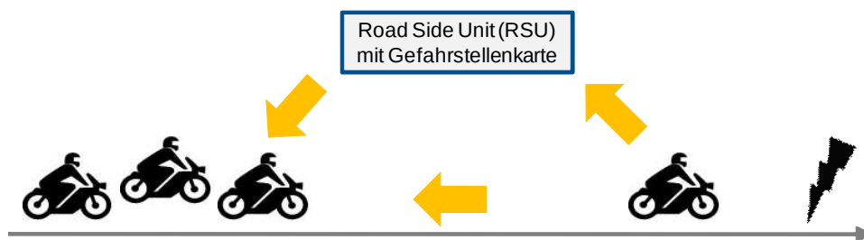
Abbildung 1.3: Funktionsweise eines kbWs
