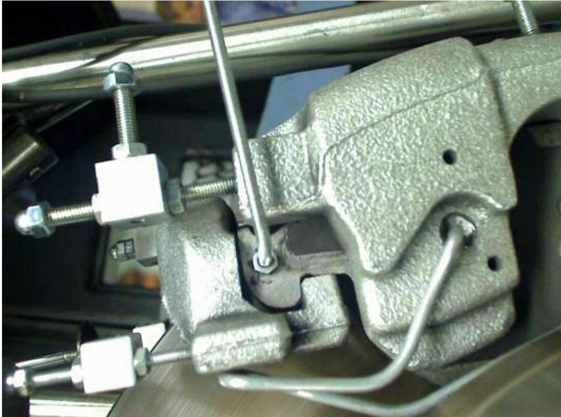
Abbildung 11-20: Messgestänge an den Hammerköpfen.
