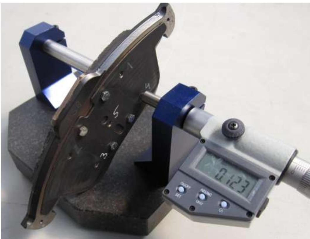
Abbildung 11-25: Belagdickenmessung nach Verschleißprogramm.
