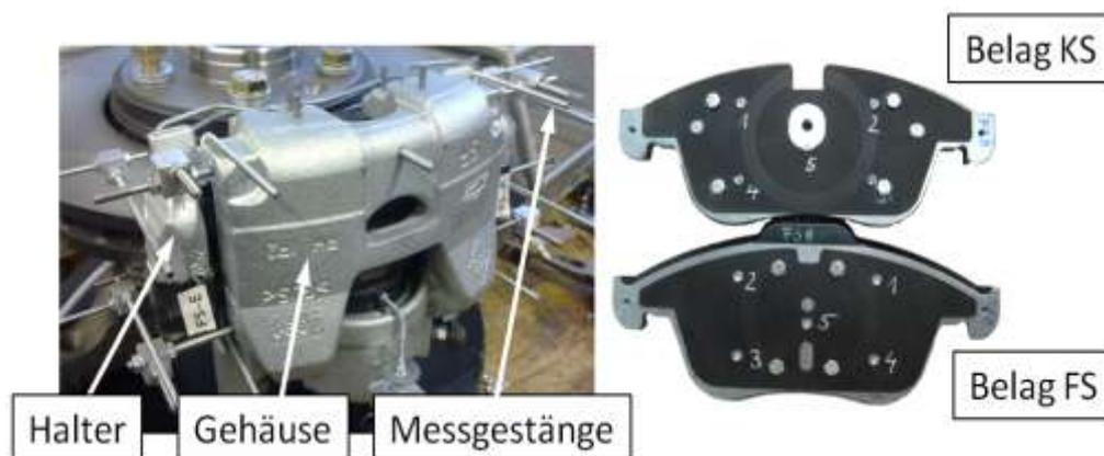
Abbildung 7-1: Referenzsystem zur Prüfung des Simulationsmodells.
