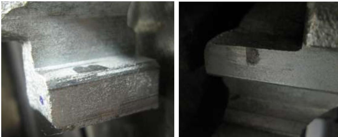
Abbildung 11-21: Auflagefläche nach Beanspruchung (links Einlauf, rechts Auslauf).
