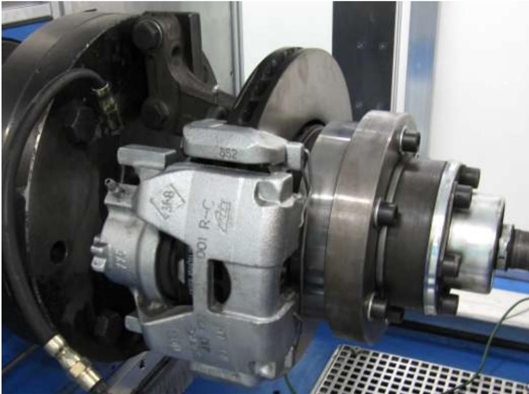
Abbildung 11-24: SMP-Aufbau für Verschleißprogramm.
