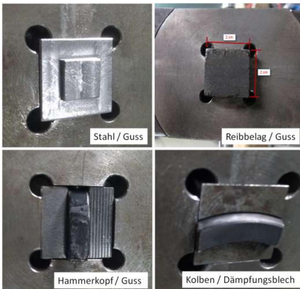
Abbildung 11-10: Materialpaarungen Reibwertprüfstand.
