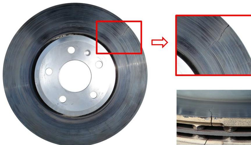
Abbildung 9.9: Ergebnisse des Rissprüfungstests einer reibgeschweißten Bremsscheibe
