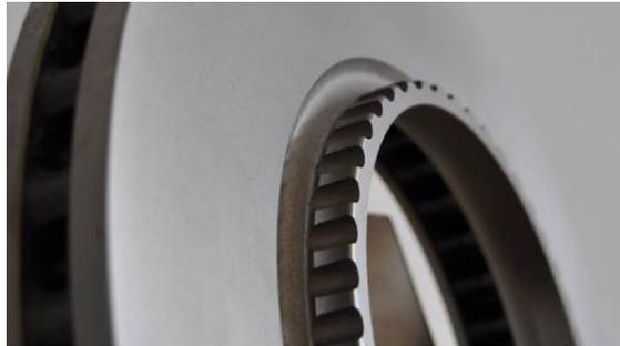
Abbildung 8.4: Verzahnungsgeometrie des Reibringkörpers
