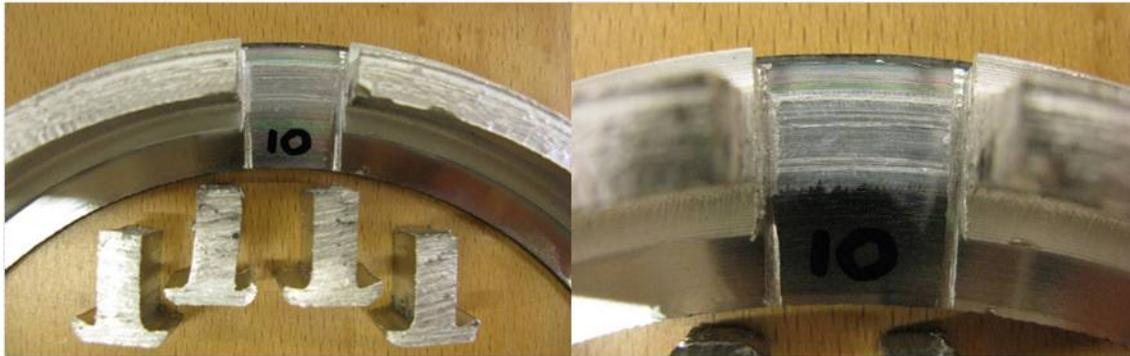
Abbildung 9.7: Ergebnisse der Biegeprüfung – Prüfling mit Probestücken (links) und Detailaufnahme des entstandenen Phasensaums (rechts)
