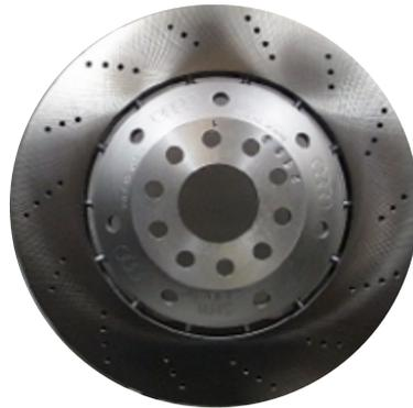
Abbildung 9.13: Verbundbremsscheibe mit Stiftverbindung zwischen Reibringkörper und Topf
