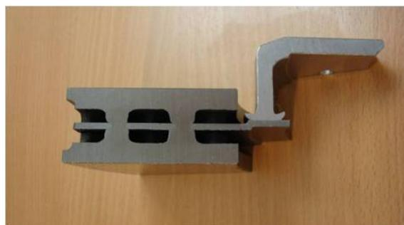
Abbildung 9.8: Segment der reibgeschweißten Leichtbau-Bremsscheibe
