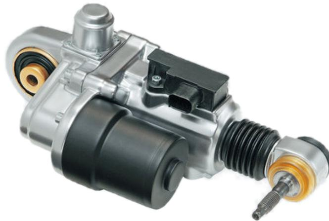
Abbildung 5.10: Spurstangenaktor der Hinterachslenkung.
