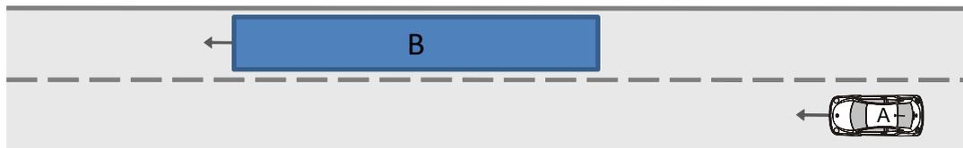
**Abbildung 2.4:** Um Mehrfachüberholung und Einfachüberholung auf ein einziges Überholmodell abzubilden, wird die variable Fahrzeuglänge genutzt: Durch Einführung eines *virtuellen Fahrzeugs* werden die beiden Realfahrzeuge „B1“ und „B2“ zum virtuellen Fahrzeug „B“ zusammengefügt.
