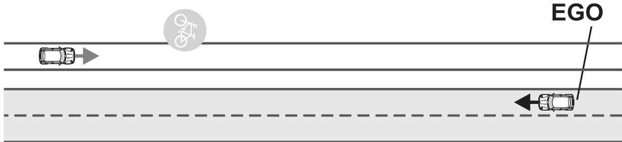
**Abbildung 5.10:** Versuchsaufbau B26: Ein von einem Versuchsfahrer bewegtes Fahrzeug fährt dem EGO-Fahrzeug mit Umfelderkassung auf dem der Fahrbahn angrenzenden Fahrradweg entgegen. Im Versuchsträger wird der laterale Abstand des detektierten Fahrzeugs zum modellierten Straßenverlauf aufgezeichnet.
