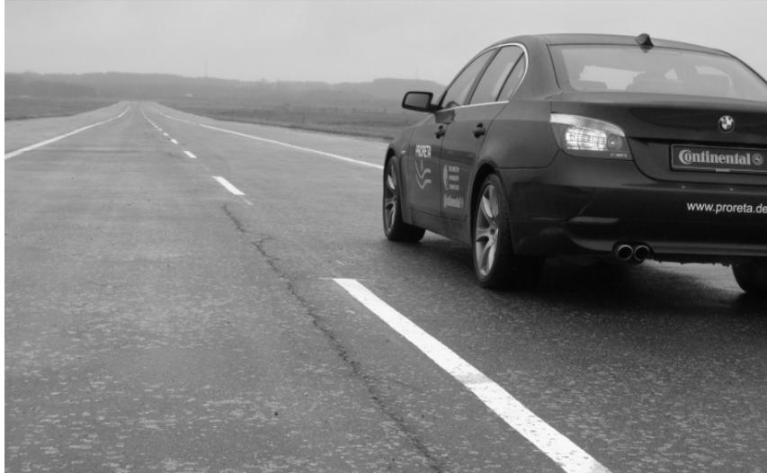
**Abbildung 3.8:** Versuchsstrecke auf dem August-Euler-Flugplatz in Griesheim. Die Strecke besitzt eine Fahrstreifenmarkierung, die in den Schlüsseleigenschaften wie beispielsweise Abmessungen und Reflexionseigenschaften, der Situation auf einer deutschen Landstraße vergleichbar ist.
