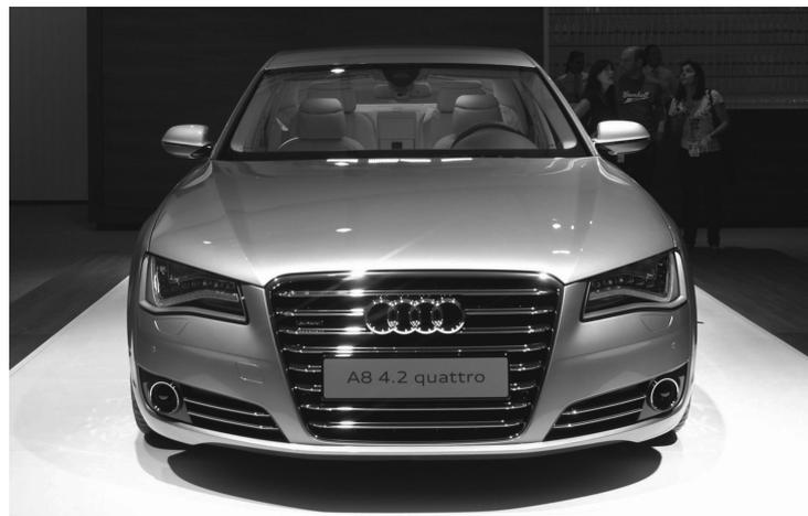
**Abbildung 4.25:** Audi A8 Modelljahr 2010. An der Stelle, an der üblicherweise Nebelscheinwerfer verbaut sind, sitzen bei diesem Modell zwei Radar-Sensoren für den ACC-Betrieb sowie Pre-Crash Anwendungen (Quelle: Audi Media Services).
