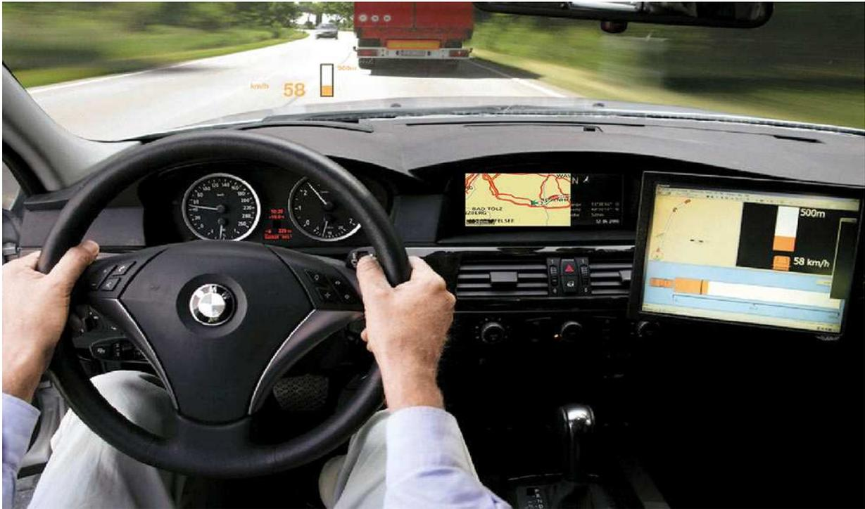
**Abbildung 1.5:** HMI des „Dynamic Pass Predictor“ von BMW. Ein Zusatzdisplay auf der rechten Seite des Armaturenbretts visualisiert dem Fahrer Informationen über potentielle Überholmöglichkeiten auf kurvigen Landstraßen (Quelle: Löwenau<sup>49</sup>).
