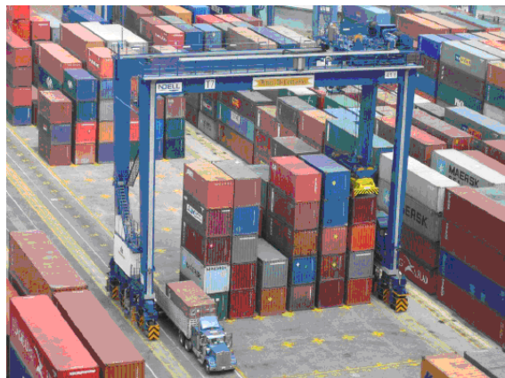
Abbildung 2.10: RTG während eines Beladevorgangs von einem Container auf einen LkW. Quelle: GOETTING (2006).
