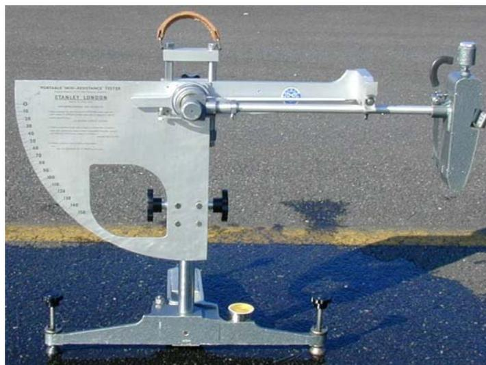
Abbildung 51: Skid Resistance Tester (British Pendulum)
