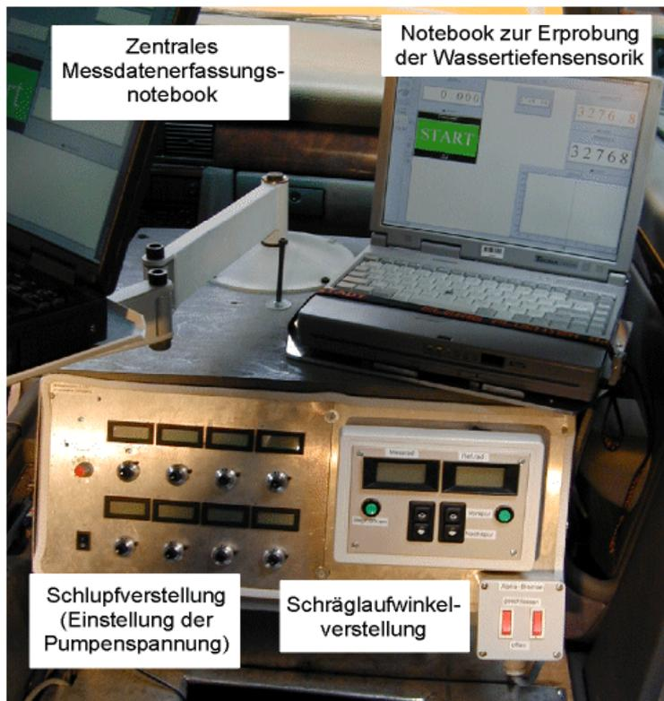
Abbildung 38: Messtechnik Innenraum AUDI V8
