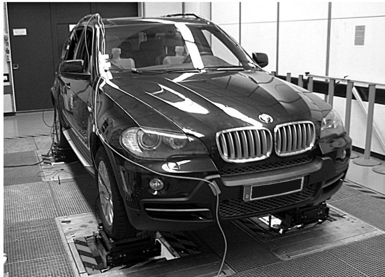
Abbildung 2.11: Versuchsfahrzeug auf dem Vierstempelprüfstand der ZF Sachs AG
