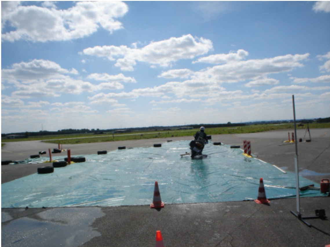
Abbildung 3.7: Versuchsaufbau bei Nutzung der bewässerten Kunststoffplanen
