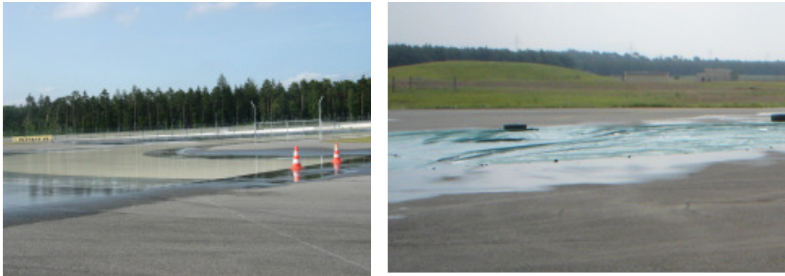
Abbildung 3.3: Epoxidharzoberfläche (links) und bewässerte und mit Kleister versehene Kunststoffplanen (rechts)
