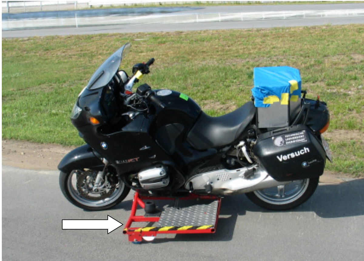
Abbildung 3.1: Versuchsfahrzeug (Pfeil: Ausleger)
