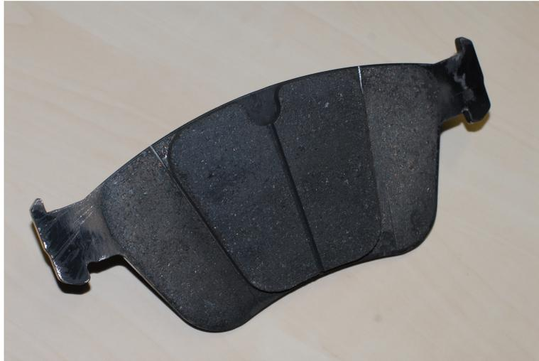
*Abbildung 6.22: Ausführungsbeispiel eines Bremsbelages mit um 50 % reduzierter Bogenlänge*
