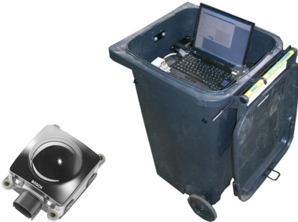
Abbildung 9.3: der zur Beobachtung des Verkehrs eingesetzte Radarsensor (links)<sup>356</sup> und eine der Verkehrsbeobachtungsstationen (rechts)
