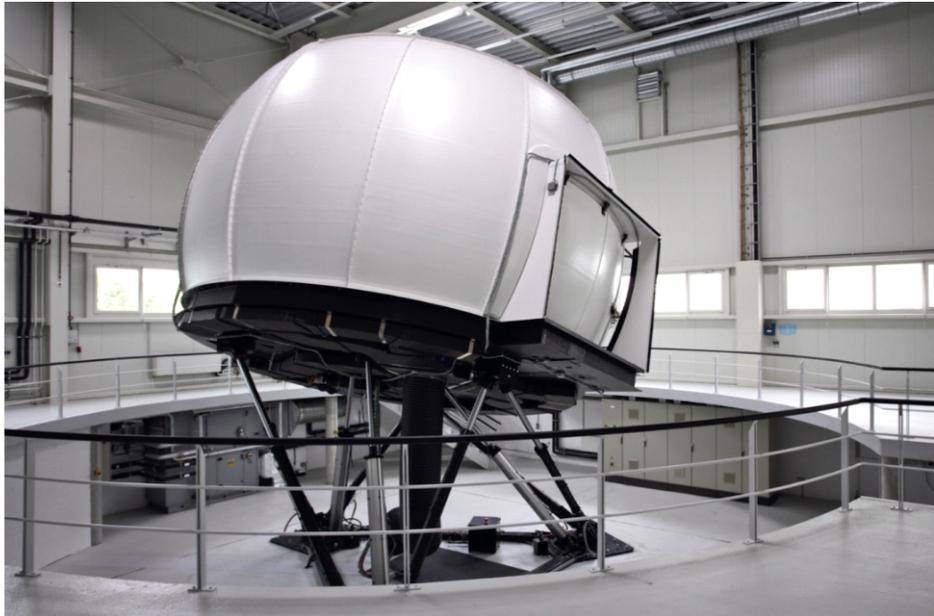
Abbildung 9.6: Der verwendete dynamische Fahrsimulator der BMW- Group<sup>361</sup>
