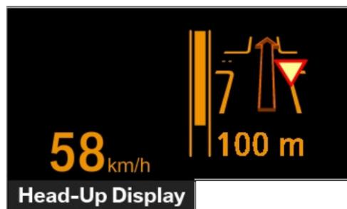
Abbildung 6.8: Information über die Verkehrsregelung als Bestandteil des Navigationshinweises<sup>12</sup>.
