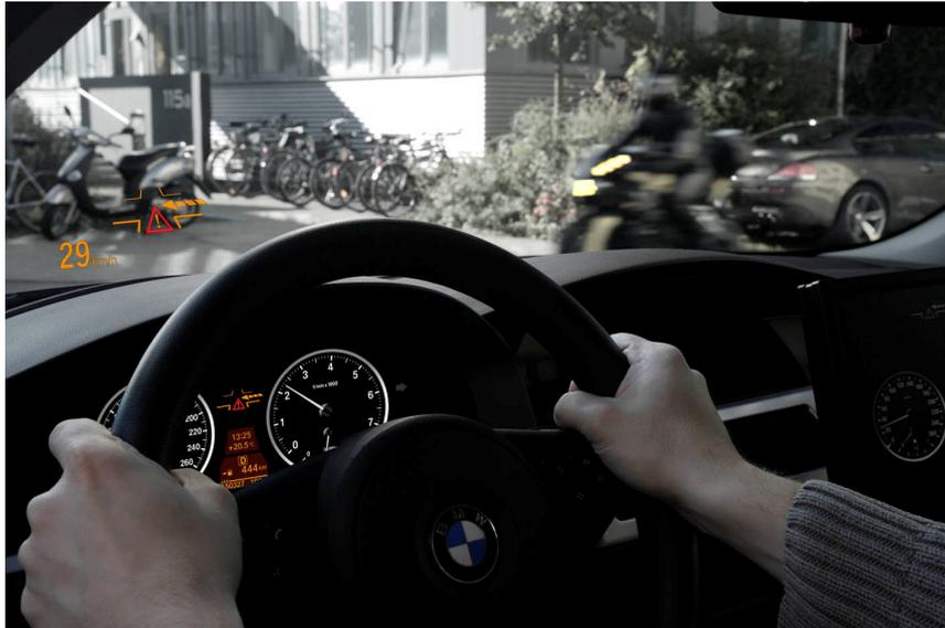
Abbildung 6.11: Warnsymbol im Head-Up Display und Instrumenten-Kombi bei einer visuell-auditiv-haptischen Warnung vor einem vorfahrtsberechtigten Motorrad.
