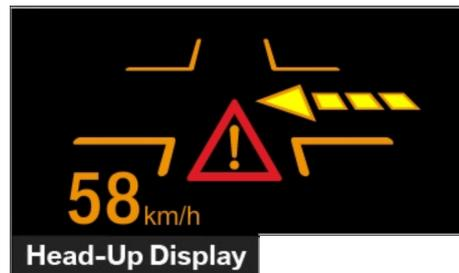
Abbildung 6.9: Warnung vor potentieller Kollision mit einem vorfahrtsberechtigten Fahrzeug von rechts<sup>13</sup>.
