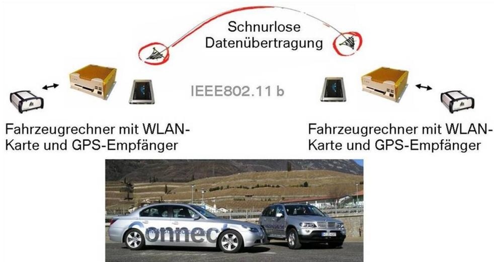
Abbildung 5.3: Messaufbau zur Analyse des WLAN-Standards IEEE802.11b.
