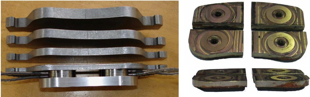
**Abbildung 3.24:** Rechts: Variation der Dicke der Rückenplatte. Links: Entlastungsnuten in der viergeteilten Belagträgerplatte
