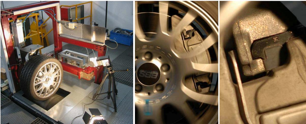
**Abbildung 8.8:** Messung der Sattelbewegung. Links: Aufbau / Mitte: Aufnahme während eines Bremsvorgangs / rechts: Vergrößerung
