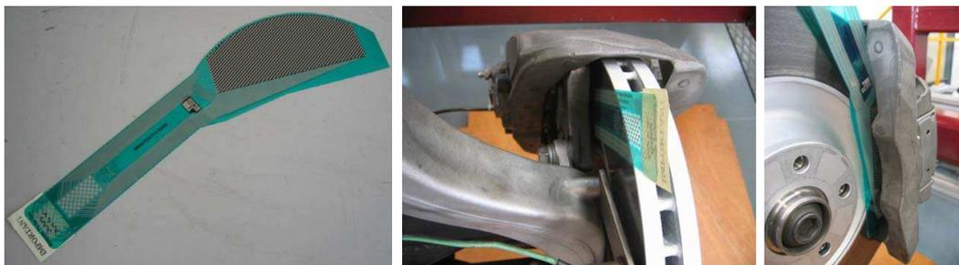
**Abbildung 8.3:** Bestimmung des kolben- und faustseitigen Anlegedrucks
