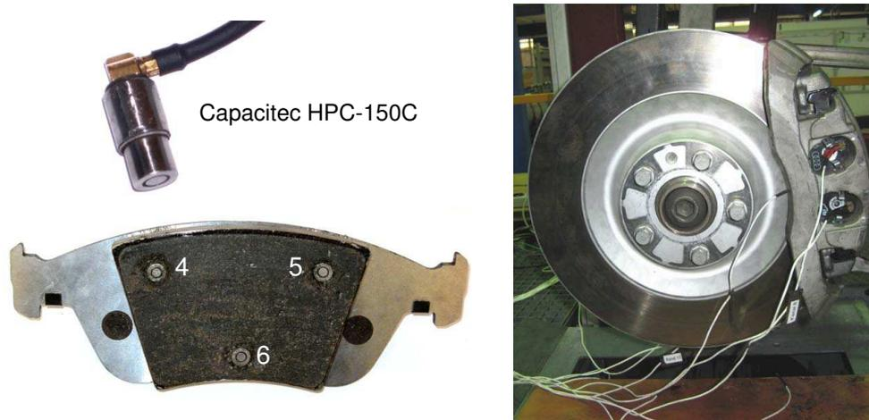
**Abbildung 8.6:** Bestimmung der Sattelaufweitung. Links: kapazitiver Sensor und Kraftmessbelag (erste Generation, FS) mit drei integrierten Sensoren. Rechts: Integration in die Radbremse
