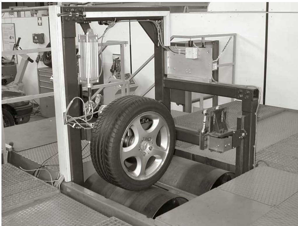
Bild 4–5: fzd -Rollenprüfstand mit Viertelfahrzeuggestell
