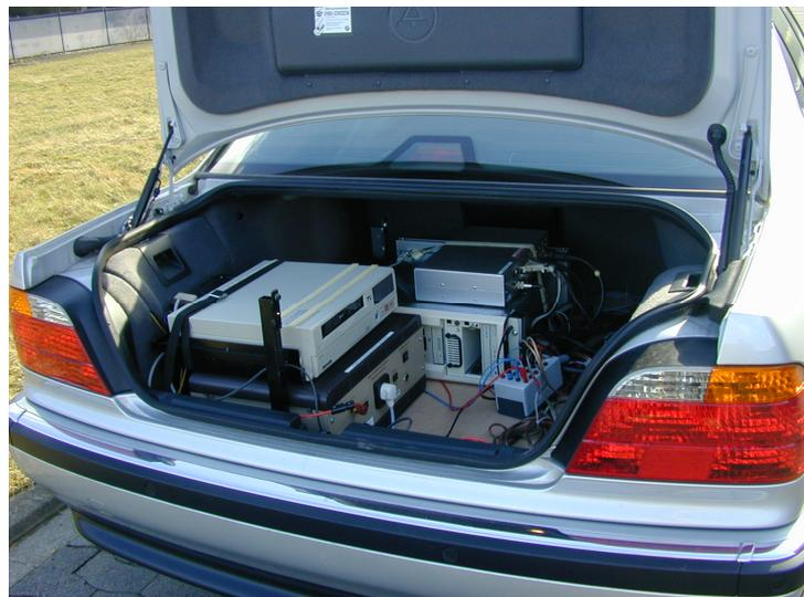
**Bild 4.5.:** Messtechnik im Kofferraum des Versuchsfahrzeuges
