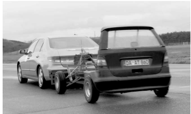
Bild 4: EVITA (bestehend aus Zugfahrzeug und dummy target).
