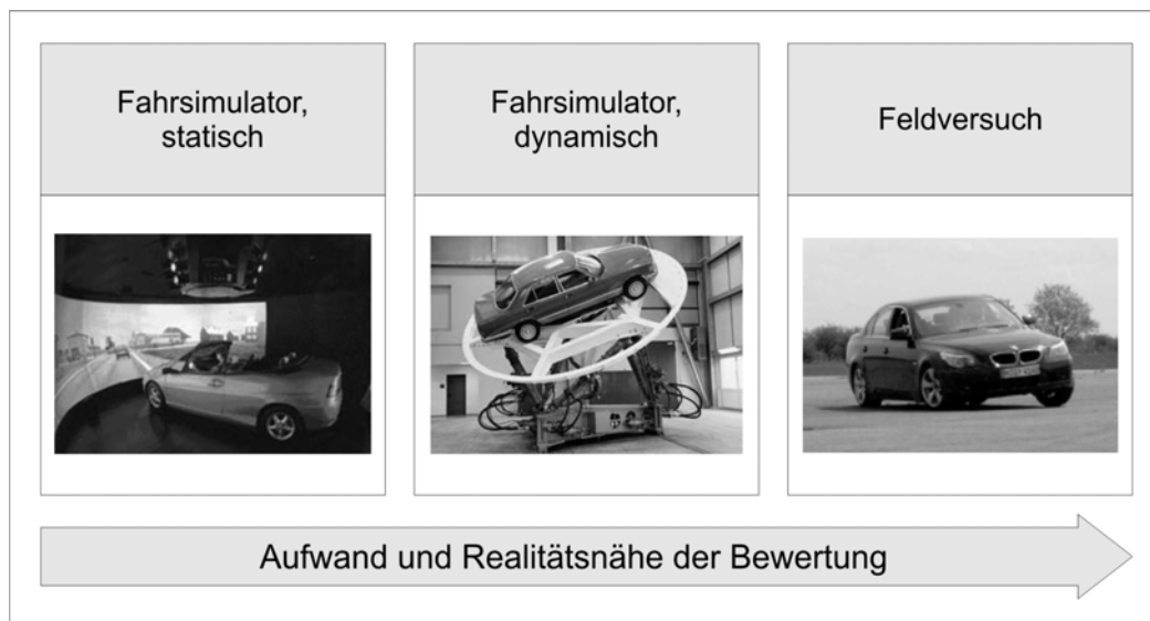
Bild 1: Überblick über gebräuchliche Testmethoden [nach 2]
